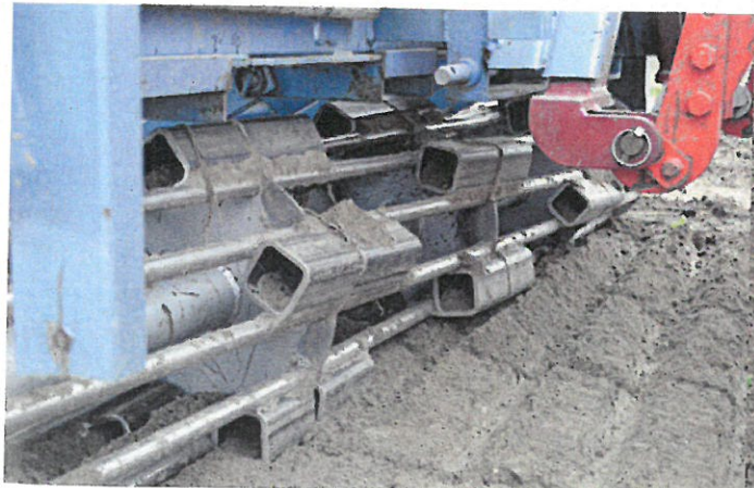
Beeld van de aangepaste kooirol op de plantmachine (L) en het resultaat na planten van de knolselder (R).
